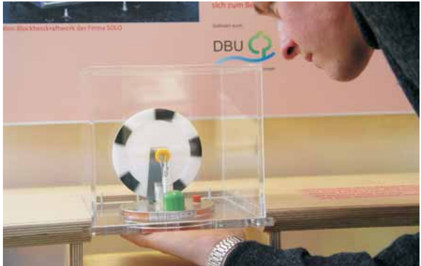
Besonderheiten des Stirlingmotors: Er nutzt externe Wärmequellen – hier die Wärme einer Hand – und hat einen hohen Wirkungsgrad.
