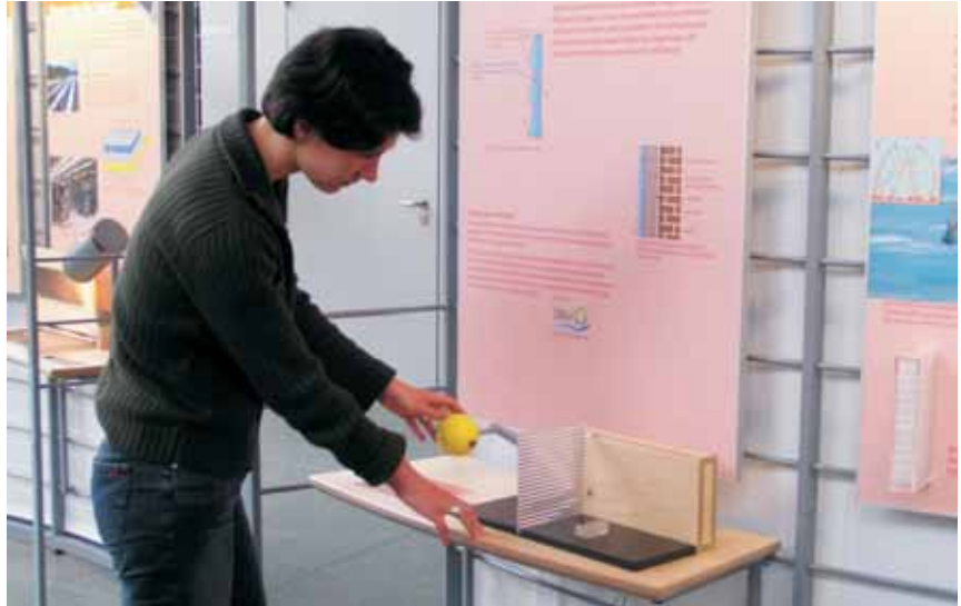
Je nach Sonnenstand lässt die Prismenscheibe die Sonnenstrahlen durch oder reflektiert sie.
